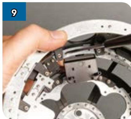
9 Придерживая гайку пальцем, переверните каркас купола и закрутите винт в гайку.
