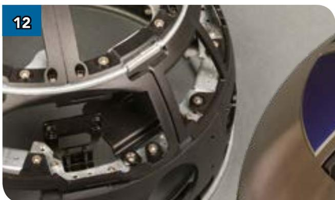
12 Так должен выглядеть результат вашей работы: крепление проектора располагается справа от большого отверстия в каркасе купола.
