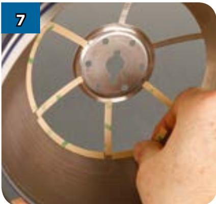
Изогнутые полоски наклейте снизу от отверстий — между наклеенными прямыми полосками.
